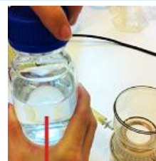
6. Cho mẫu nước vào hệ thống Laboratory Filtration
