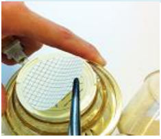
8. Lấy màng đếm ra khỏi hệ thống Laboratory Filtration
