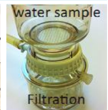
7. Bật hệ thống Laboratory Filtration để lọc mẫu nước
